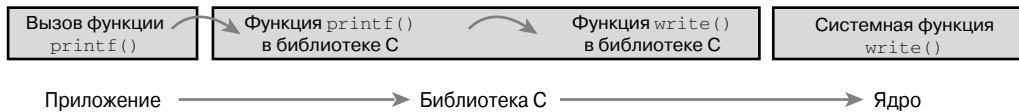
Рис. 5.1. Взаимосвязь между приложениями, библиотекой C и ядром на примере вызова функции printf()
